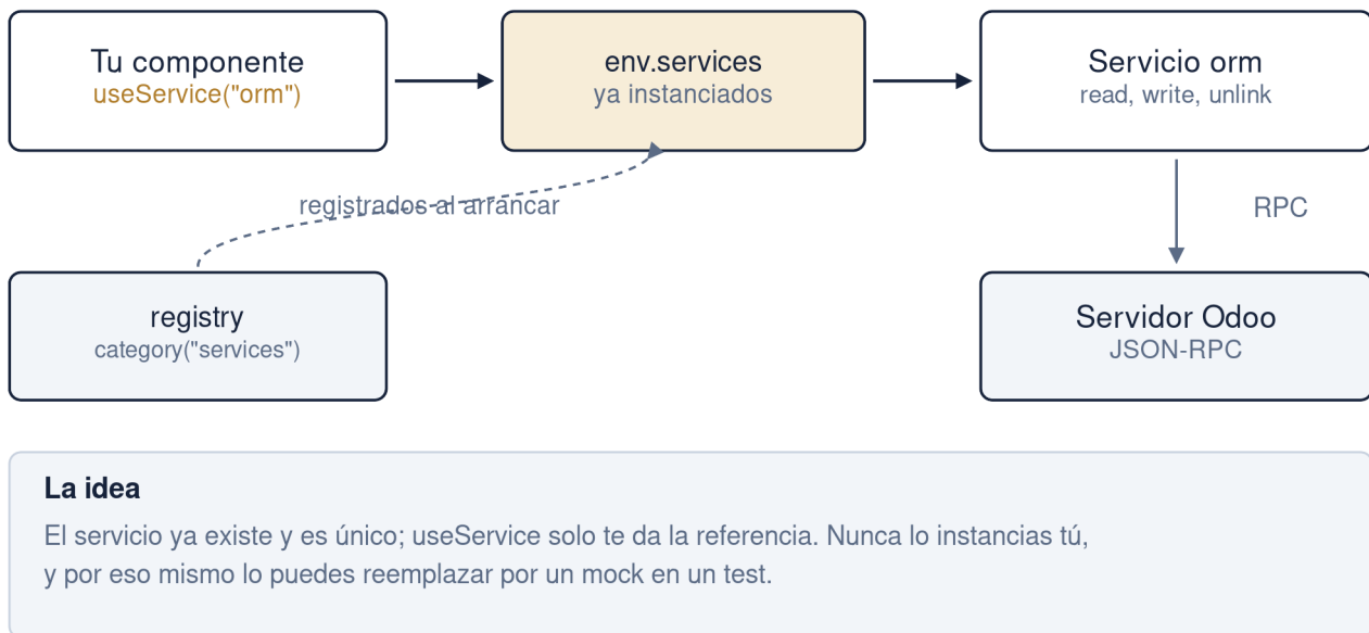
Figura 5: De useService al servidor: el servicio ya existe, tú solo recibes una referencia.
